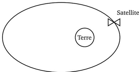
2. Deuxième loi de Képler appliquée aux satellites de la Terre : dans le référentiel géocentrique, le rayon vecteur  $\vec{TS}$  reliant le centre d'inertie T de la Terre et le centre d'inertie S du satellite balaye des aires égales pendant des durées égales.
